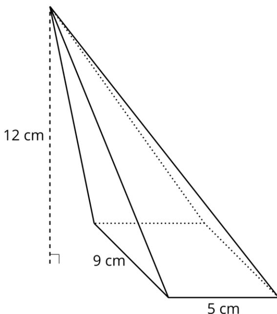
Par exemple, pour trouver le volume de cette pyramide rectangulaire, commencez par calculer l'aire de la base, qui est de 45 centimètres carrés car  $5 \cdot 9 = 45$ . Remplacez maintenant 45 et 12 dans la formule du volume pour trouver que le volume de la pyramide est de 180 centimètres cubes :
